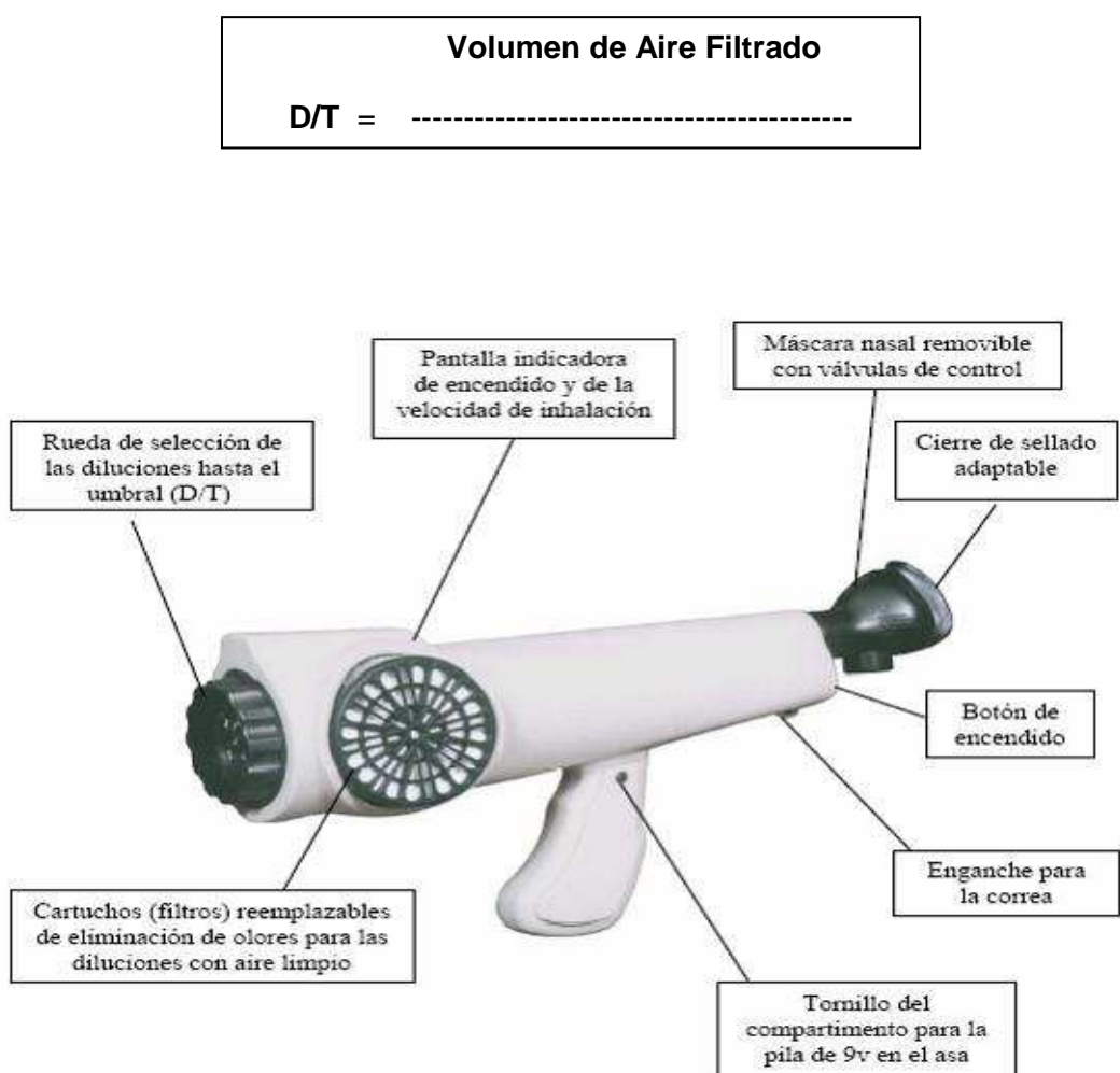
Figura 1. Diagrama de los componentes principales del Nasal Ranger™
