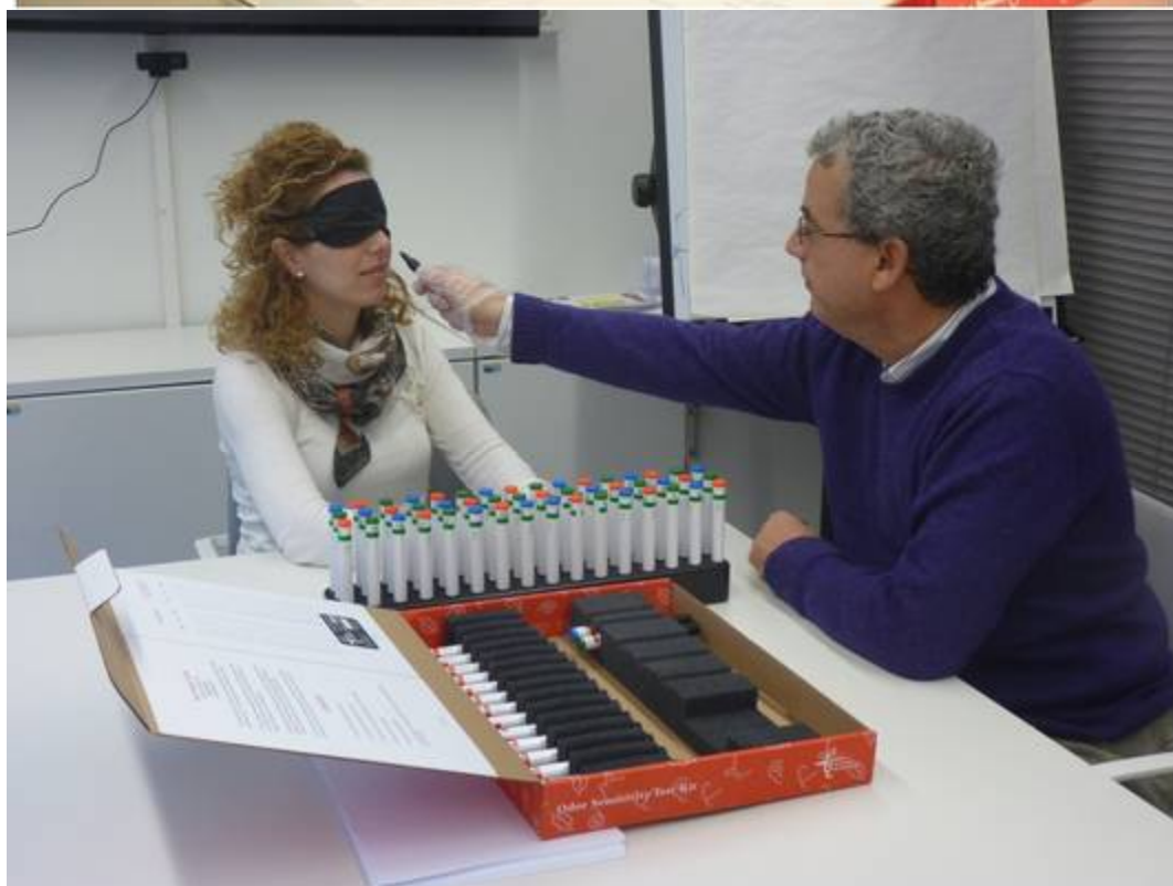
Calibración de la sensibilidad olfativa individual al n-butanol (previa a las mediciones)
